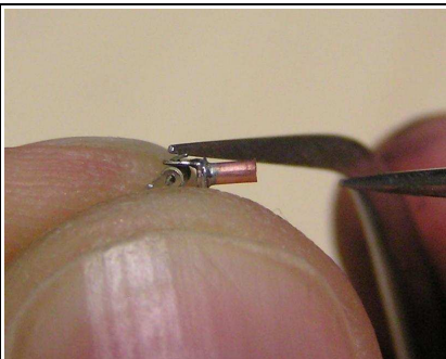
Abb.27: Die Enden des Kreuzstückes nach hinten biegen. Das verhindert ein Aufbiegen der Gabeln bei Belastung.
