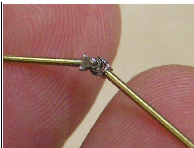
Abb.38: Fertige Gelenkwelle mit direkt eingelöteten Wellen. Alle anderen Arbeitsschritte sind zur Anleitung oben gleich. Man kann die verschiedenen Möglichkeiten natürlich auch kombinieren. Siehe dazu auch in die technische Zeichnung.
