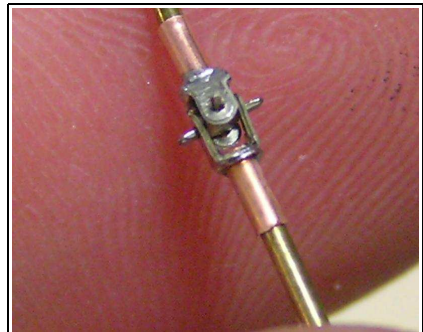
Abb.26: Das Ergebnis nach dem Verlöten sollte so aussehen.
