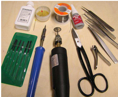
Abb.1: Werkzeuge: Schere, Pinzetten, Minibohrmaschine, Lötkolben, Flussmittel bzw. Löffett, Kleber (Loctite 648), konische Reibahlen 0,2 bis 1,5mm, Stecknadel, Fingernagelzwicker
