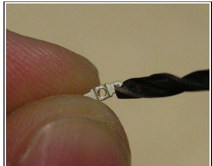
Abb.5: Löcher mit größerem Bohrer entgraten.
