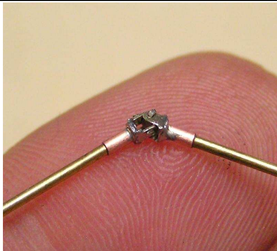
Abb.30: Welle zum Schluss auf Funktion prüfen. Anfangs läuft sie noch schwer. Das gibt sich aber. Man kann die Welle auch vorsichtig in der Bohrmaschine einlaufen lassen. Dafür muss das abgewinkelte Ende der Welle aber immer gut geführt werden. Der Wellendurchmesser 0,8mm lässt sich mit aufgeklebten Kupferbuchsen wieder auf 1mm ändern. Z.B. um Zahnräder aufkleben zu können, oder Felgen aufzustecken.
