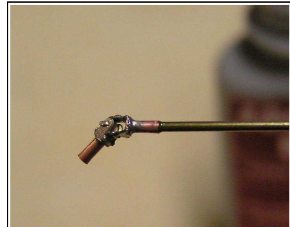
Abb.29: 0,8mm Welle erst mit Loctite 648 einkleben wenn man sicher ist, dass man sie für die Montage im Modell nicht mehr trennen muss.
