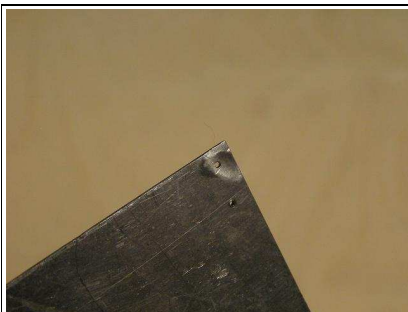
Abb.6: Hilfsmittel 1mm dickes Blech mit 0,8mm Bohrung herstellen.
