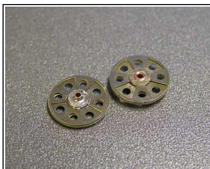
Abb.18: Die beiden Umlenkrollen sind ca. 0,8mm im Durchmesser kleiner als die Tragrollen. Die Kanten müssen entgratet werden.
