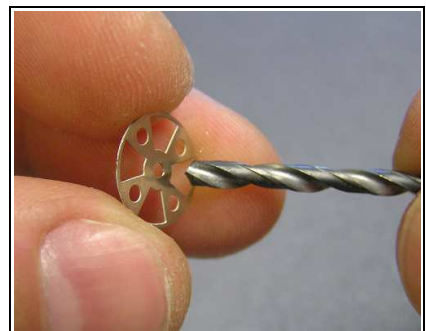
Abb.5: Das mittlere Loch bei allen 6 Scheiben auf beiden Seiten mit einem Bohrer entgraten.
