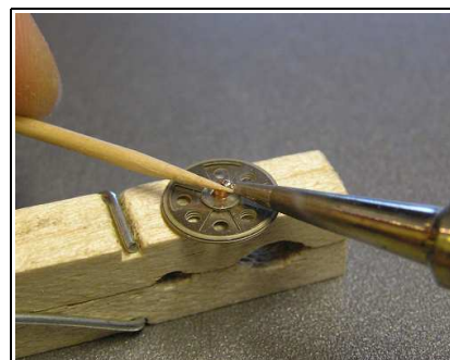
Abb.16: Die Buchse einlöten. Darauf achten, dass alle 3 Scheiben verlötet sind.
