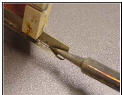
Abb.44: die Kante verzinnen. So wird das Chassis stabil.
