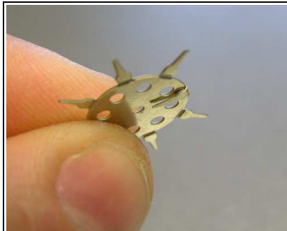
Abb.22: Die erste Spitze ist gebogen und zeigt genau zum Mittelpunkt.
