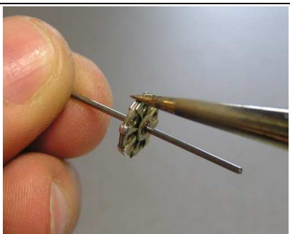
Abb.36: Die Scheiben an der Stelle der Mitnehmer seitlich miteinander verlöten.
