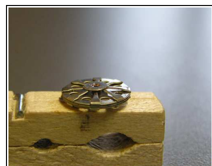
Abb.32: Das Treibrad auf eine schlecht wärmeleitende Unterlage legen (Bsp. Holzklammer).
