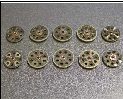
Abb.39: Fertiger Radsatz für den Menck 154. Menck 152 hat je eine Tragrolle weniger.
