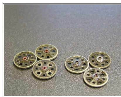
Abb.19: Die 6 Tragrollen werden genau so gefertigt wie die Umlenkrollen. Der M152 hatte nur 4 Tragrollen und entsprechend weniger Kettenglieder.
