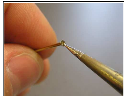
Abb.50: Scheibe nur stirnseitig mit dem Draht verlöten.
