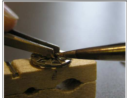
Abb.35: Das Zinn muss so verlaufen, dass alle Scheiben mit der Kupferbuchse verbunden sind.
