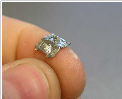
Abb.30: Die ersten beiden Glieder sind verbunden und bewegen sich nur durch ihr Eigengewicht. (wichtig für das Fahrbild!)
