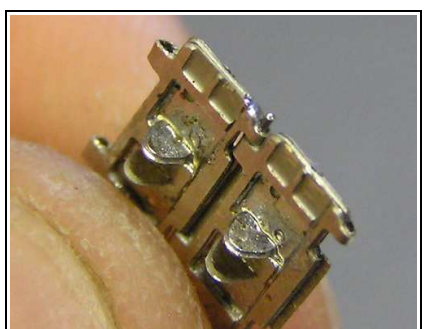
Abb.26: ...und darauf achten, dass kein Zinn zur nächsten Öse durchläuft. Kurze Verweildauer des Lötkolbens!
