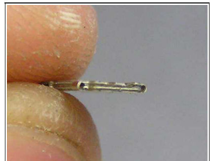
Abb.11: Die Bleche sollten ohne zusätzlichen Druck direkt aufeinander liegen.
