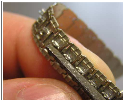
Abb.31: Die Spitzen an den Mitnehmern entgraten. Die Laufräder müssen ohne zu klemmen in den Schlitz passen.
